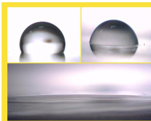
Variazione dell'angolo di contatto di PDMS, in funzione del tempo di esposizione al plasma, per differenti valori di pressione. I riquadri mostrano micrografie della goccia, prima e dopo il trattamento con plasma ad aria
