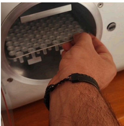
1 I cappucci in LDPE, sul vassoio, entrano nella camera del Tucano.
